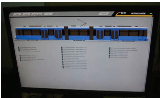
Rys. 5. Interfejs programu instruktora – zakładka z modulem usterek tramwaju [fot. M. Górski]
