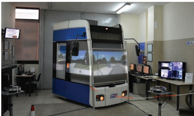
Rys. 6 Widok ogólny stanowiska symulatora [fot. M. Górowski]
