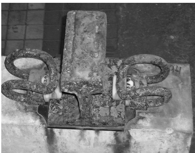
Rys. 7. System przytwierdzenia szyny w torze po badaniu odporności na oddziaływanie trudnych warunków środowiska
