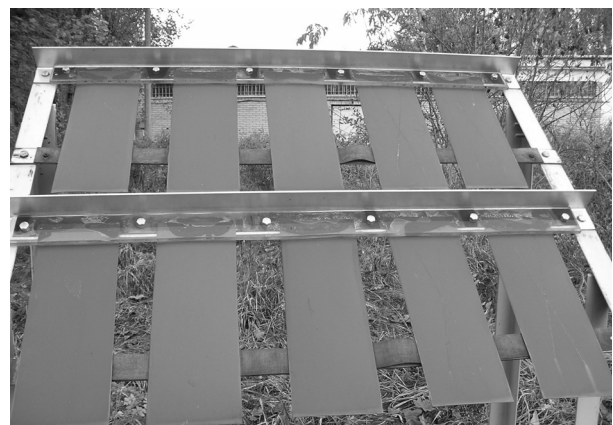
Rys. 1. Badania terenowe powłok lakierowych
