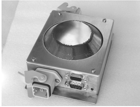
Fig. 4. Multifunction RFMF sensor
