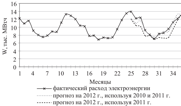
Рис. 1. Результаты прогноза месячных расходов электроэнергии для исследуемой тяговой подстанции по методу сезонной волны
