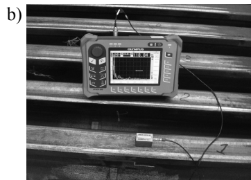
Rys. 5. Badanie złączy szynowych: a) penetracyjne, b) ultradźwiękowe
