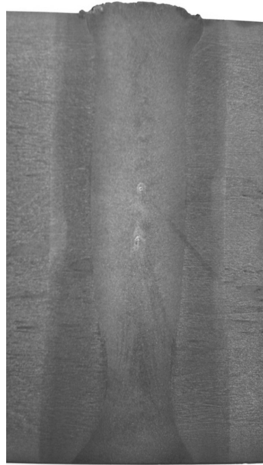
Rys. 9. Makrostruktura złącza spawanego z luzem 25 mm
