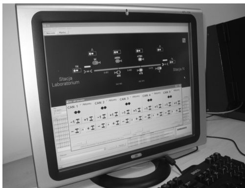
Rys. 4. Symulator blokady SHL-12 z możliwością zmiany ilości przejeżdżanych osi pojazdów kolejowych, zaprojektowany na potrzeby Laboratorium Systemów SRK [fot. M. Kornaszewski]
