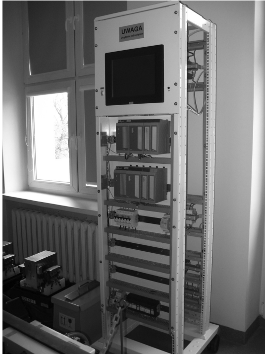
Rys. 8. Laboratoryjne stanowisko licznikowego systemu stwierdzania niezajętości odcinków torowych typu SOL-21 (a) z aparaturą sterującą i monitorem dotykowym (b) [5, fot. M. Kornaszewski]
