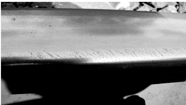
Rys. 23. Wada powierzchniowa ( head checks ) w postaci ukośnych nadpęknięć na wewnętrznej krawędzi szyny [42]
