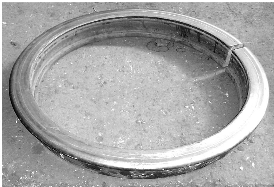
Rys. 14. Widok pękniętej obręczy
