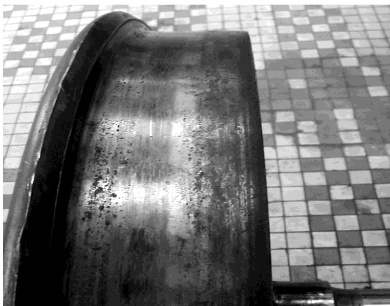
Rys. 13. Widok powierzchni obręczy ze ściętym obrzeżem i śladami tarcia w środkowej części powierzchni tocznej
