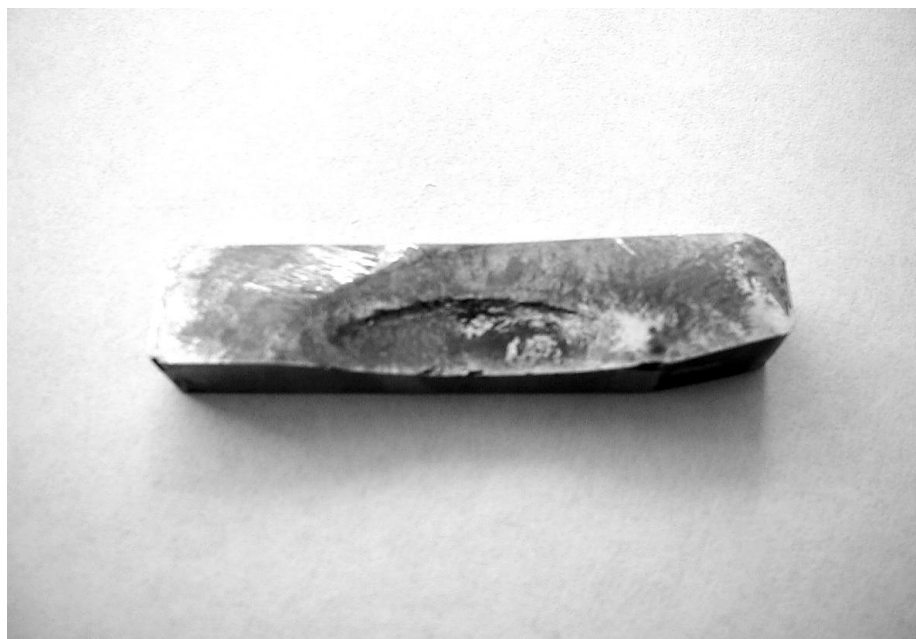
Rys. 4. Przełom pierścienia wewnętrznego pękniętego łożyska
