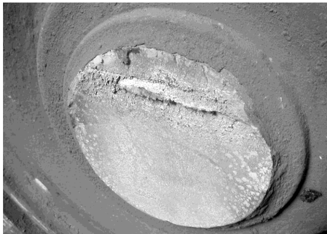
Rys. 8. Pęknięta oś w płaszczyźnie koła
