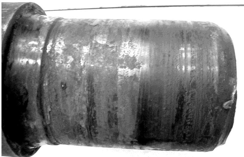
Rys. 7. Wady czopa osi powstałe na skutek tarcia pierścieni łożysk
