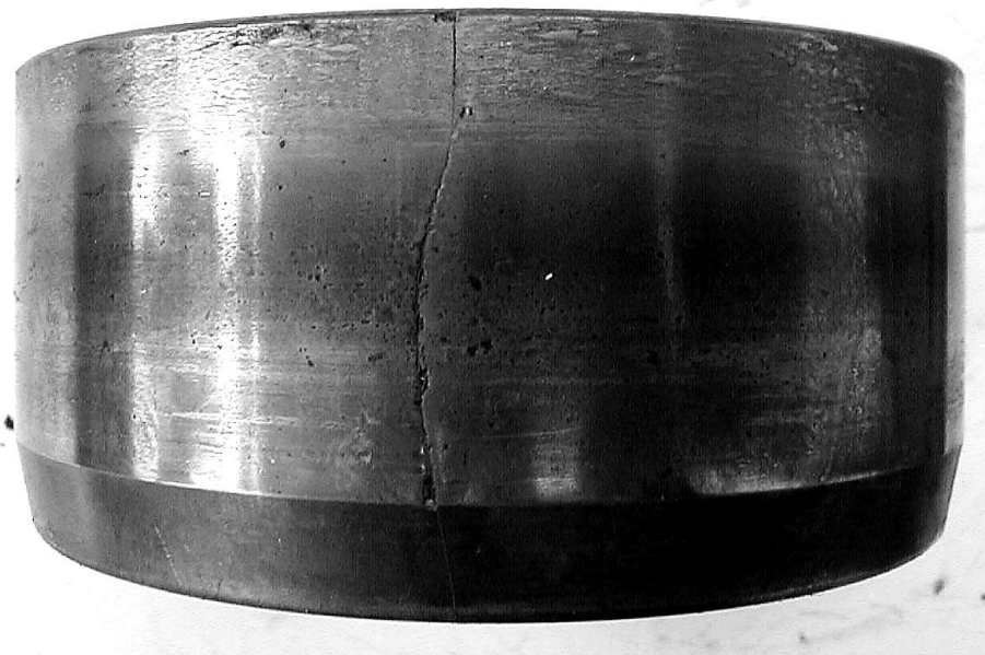
Rys. 3. Pęknięcie oraz wady powierzchniowe pierścienia łożyska
