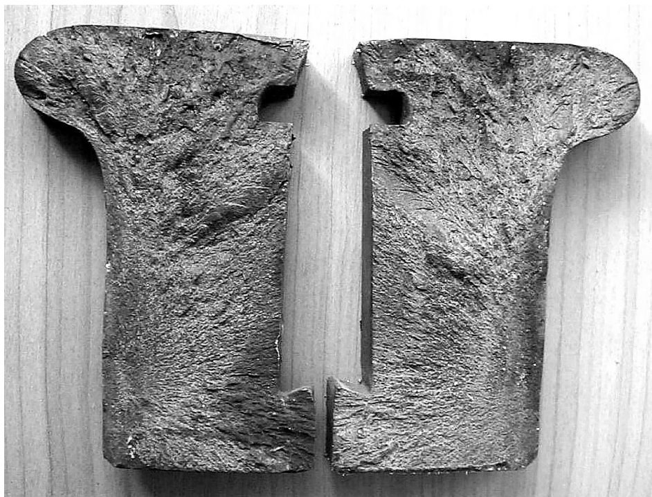
Rys.16. Przełom pękniętej obręczy
