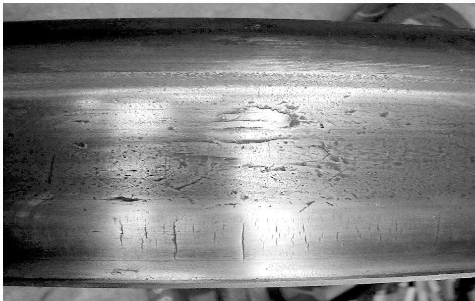
Rys. 15. Wady na powierzchni tocznej obręczy
