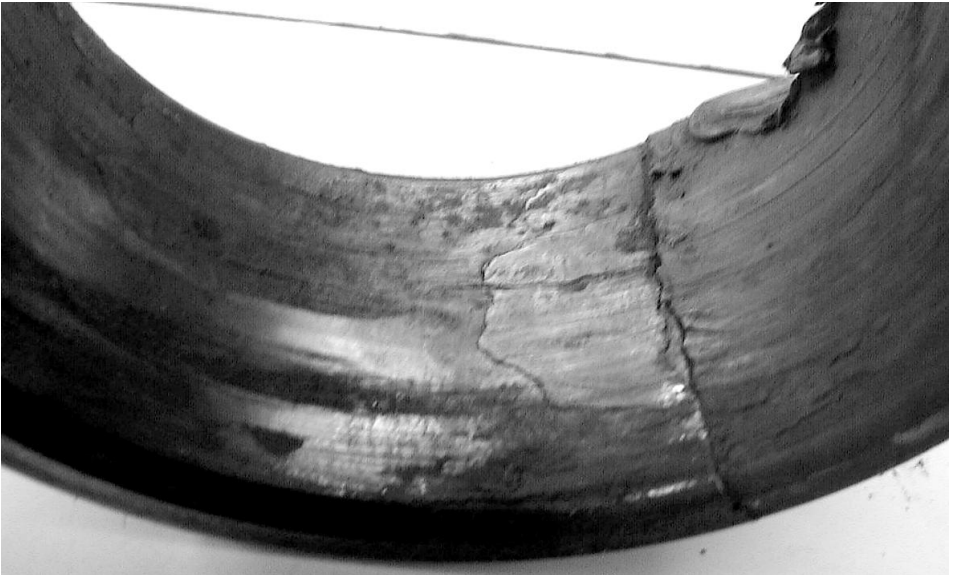
Rys. 6. Pęknięcie oraz powstałe nalepienia na pierścieniu wewnętrznym łożyska
